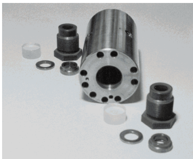
Abbildung 2. Sichtzelle mit Dichtungen und Saphirfenstern zur Messung von Phasengrenzlinien und Dichten in SCW. Für Einzelheiten siehe Text.
